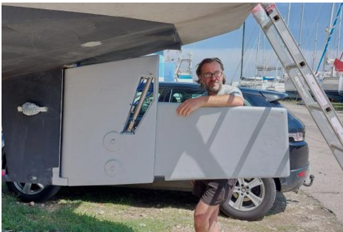
Hochklappbares Ruderblatt. Im Flachwasser und in Tidenrevieren ein unschlagbarer Vorteil
