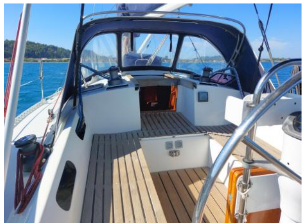
Stauraum unter dem Cockpitboden (Deckel aufgestellt links im Bild)
