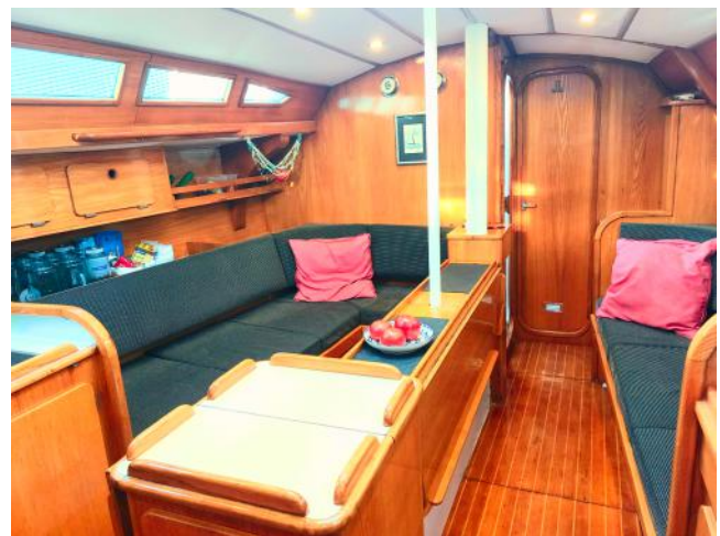
Der Salontisch ist am Schwertkasten angebracht. Die Seiten können einzeln weggeklappt werden.
