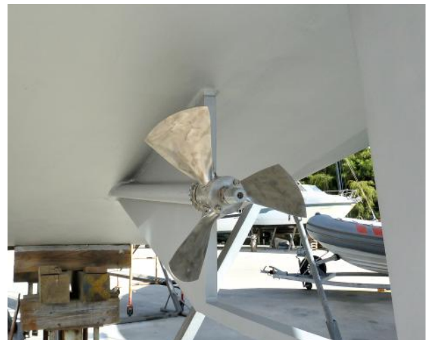
Gut geschützt, der Drehflügelpropeller
