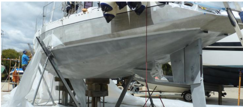
Nach dem Sandstrahlen vor Aufbringen der ersten Primerschicht
